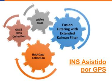
Con el INS asistido por GPS, la navegación inexacta se autocorrige por medio de filtros Kalman y algoritmos correctivos de ruta incluso en la configuración de interrupción del GPS.
